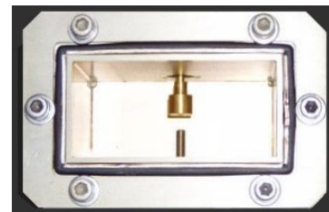
Bild 19: Sonde im Hohlleiter für 2,7 GHz mit kapazitiver Abstimmerschraube
