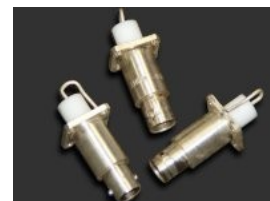
Bild 20: Koppelschleifen für etwa 1060 MHz an BNC-Buchsen
