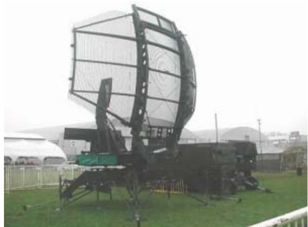
Bild 10: schon das recht betagte AN/TPS-43 nutzte Puls-kompression mit Phasenmodulation mit der Länge von 13 Codes
