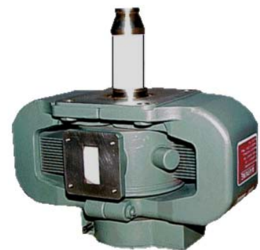
Abb. 14: Magnetron VMX 1090 für eine Festfrequenz, eingesetzt im PAR-80. Dieses Magnetron enthält sogar die zur Arbeit nötigen Permanentmagneten.
