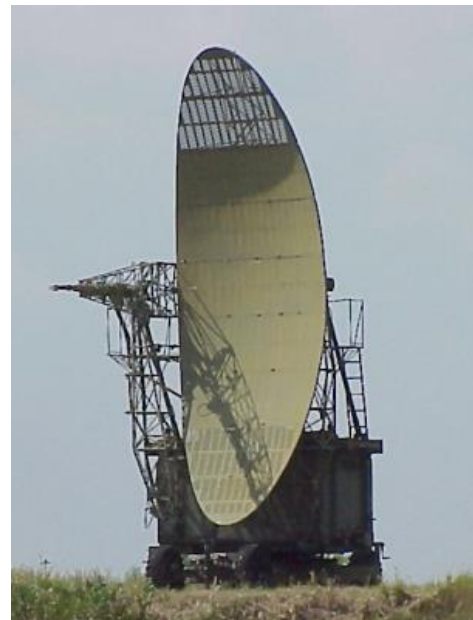
Abb. 12: Typische Antennenform eines Höhenfinders mit einem liegenden Fächerdiagramm
