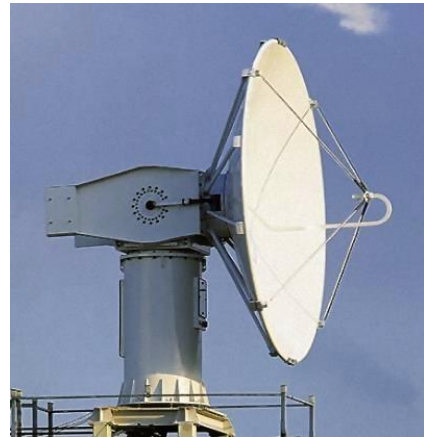
Abb. 8: Parabolantenne des Wetterradars „Meteor“ von AMS Gematronik
