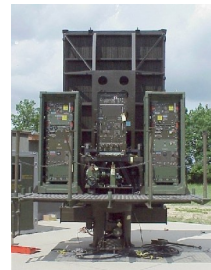
Abb. 12: PAR-80, ein typisches Precision Approach Radar
