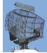
Abb. 10: SRE-M7, ein typisches „En-Route“ Radar der DASA
