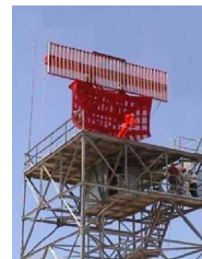
Abb. 11: ASR-12, ein typisches Air Surveillance Radar
