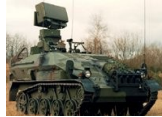
Abb. 14: Das „Feuerleitwiesel“ mit einem Radar von Ericsson
